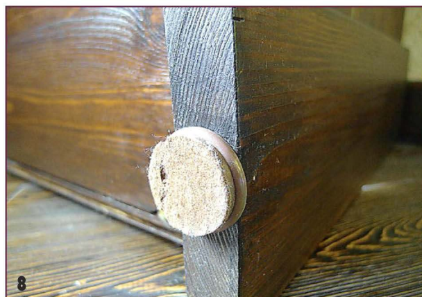
Чтобы сундук не царапал пол при перемещении, снизу к боковым стойкам приклеены войлочные подпятники.
