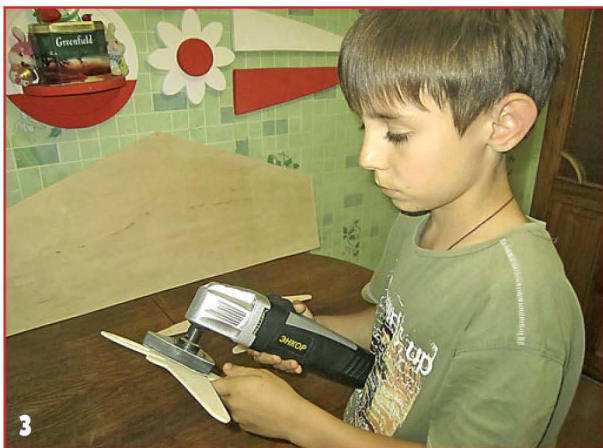
Поверхности выпиленных самолётиков перед покраской следует отшлифовать.
