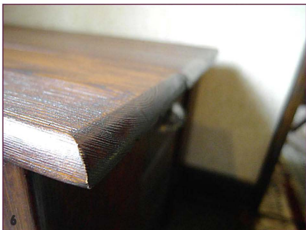
Верхние рёбра у кромок досок по краю крышки скруглены.
