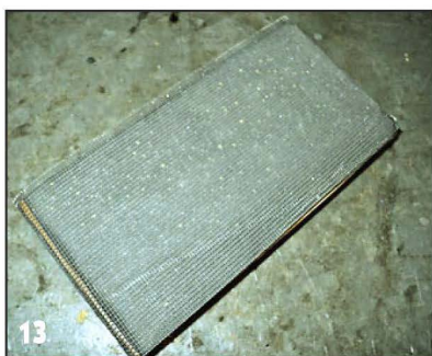
12 13 Чтобы окончательно отшлифовать уже пропитанный грунтом паркет, использовал тёрку с сеткой зернистостью 180.
