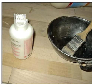
Для нанесения клея на подложку приспособил флакон с насадкой, используемый при окрашивании волос.
