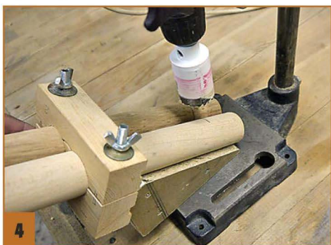
4 Чашки в черенках-«брёвнышках» высверливал кольцевой пилой Ø38 мм.
