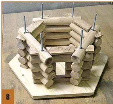
8 Из пропитанных лазурью деталей сруб был собран на клее...
