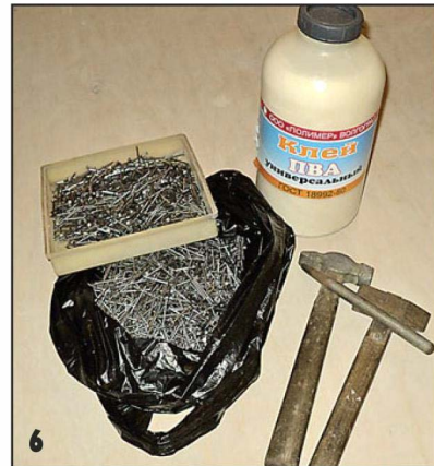
Для укладки паркета приобрёл клей, мелкие гвозди, подготовил инструменты.
