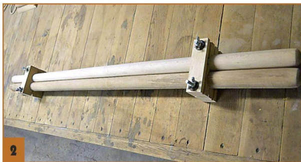
2 Чтобы при высверливании чашек в черенках они не расходились, было изготовлено два зажима.
