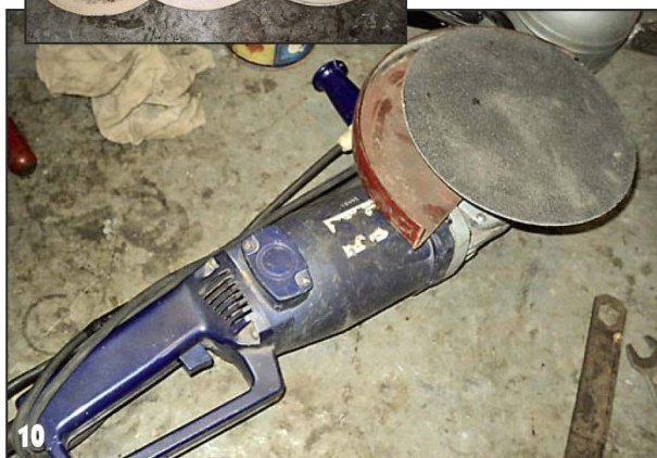
10 Шлифовал паркет болгаркой с насадкой для шлифовальных кругов на липучке.
