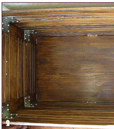
2 Сундук собран с использованием металлических уголков.
